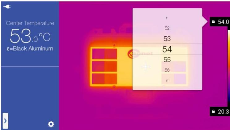
Una vez seleccionado el valor, se puede cerrar la ventana de cambio de la temperatura haciendo clic en cualquier lugar fuera de su campo en la pantalla. Además, moviendo la palanca de mando hacia arriba o hacia abajo se ajusta ambos valores extremos en la barra de temperatura. Al hacer clic en la palanca de mando se activa el enfoque (capítulo 3.3).
