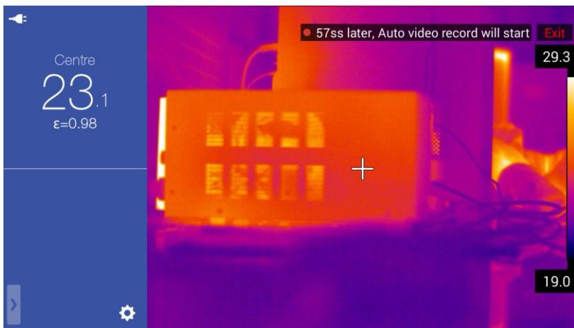
Después de pasar el tiempo especificado la cámara iniciará el proceso de grabación, el procedimiento y el aspecto de la pantalla es como en modo manual. Después de la grabación del vídeo de acuerdo con el tiempo especificado, la cámara detendrá automáticamente el proceso de grabación y grabará el vídeo en la memoria, a continuación, volverá al modo de tiempo real.
